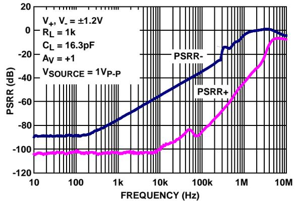
FIGURE 10. PSRR vs FREQUENCY,  $V_+, V_- = \pm 1.2V$
