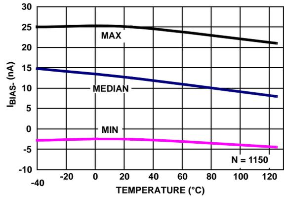
FIGURE 25.  $I_{BIAS-}$  vs TEMPERATURE,  $V_+, V_- = \pm 2.5V$
