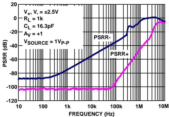
FIGURE 11. PSRR vs FREQUENCY,  $V_+, V_- = \pm 2.5V$
