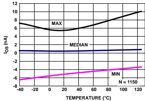
FIGURE 29.  $I_{OS}$  vs TEMPERATURE  $V_+, V_- = \pm 1.2V$
