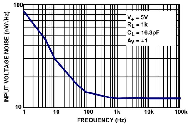
FIGURE 12. INPUT VOLTAGE NOISE DENSITY vs FREQUENCY
