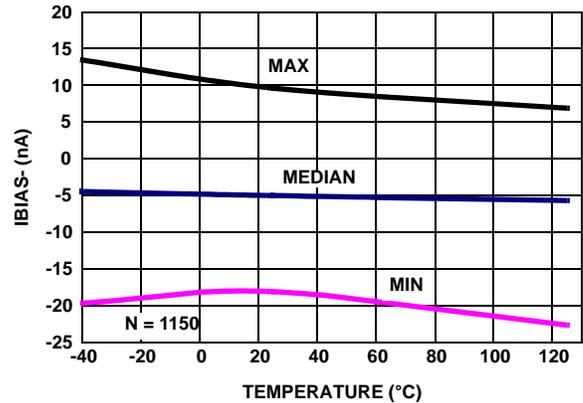
FIGURE 27.  $I_{BIAS-}$  vs TEMPERATURE,  $V_+, V_- = \pm 1.2V$
