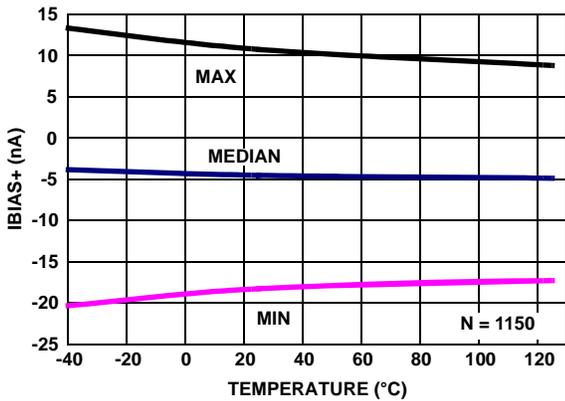
FIGURE 26.  $I_{BIAS+}$  vs TEMPERATURE,  $V_+, V_- = \pm 1.2V$
