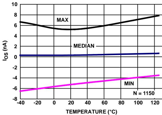
FIGURE 28.  $I_{OS}$  vs TEMPERATURE  $V_+, V_- = \pm 2.5V$
