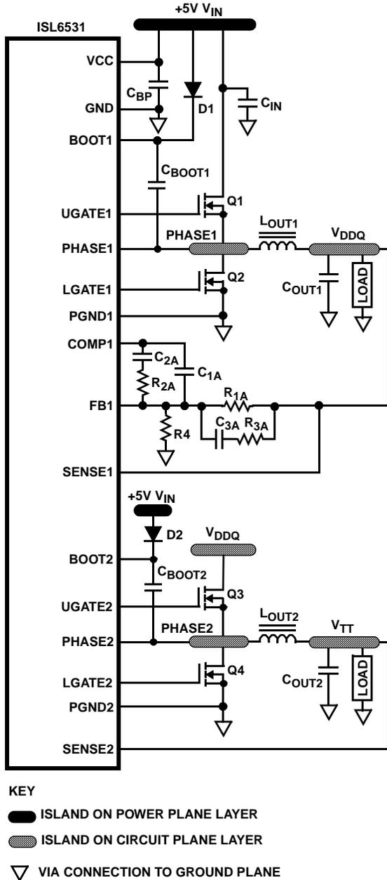
FIGURE 7. PRINTED CIRCUIT BOARD POWER PLANES AND ISLANDS
