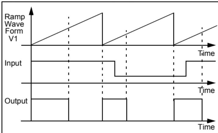
**FIGURE 11-2: PWM CIRCUIT**
