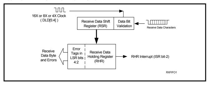
FIGURE 17. RECEIVER OPERATION IN FIFO AND AUTO RTS FLOW CONTROL MODE
