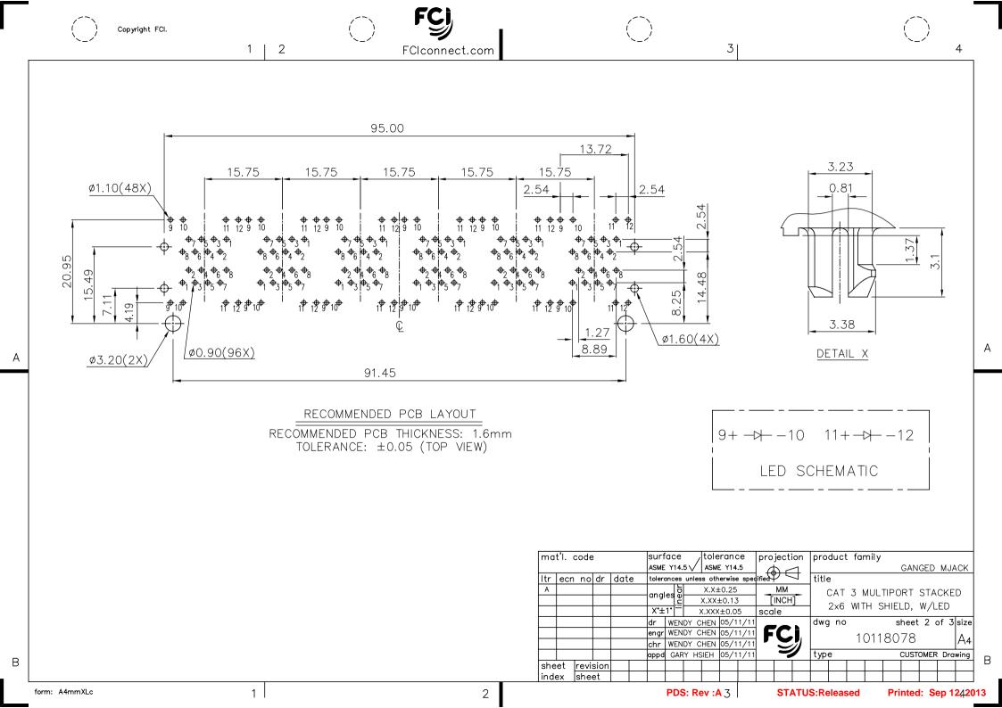
TOP HOUSING: HIGH TEMPERATURE THERMOPLASTIC, UL94V-0, COLOR: BLACK. BOTTOM HOUSING: HIGH TEMPERATURE THERMOPLASTIC, UL94V-0, COLOR: BLACK. CONTACTS: COPPER ALLOY.
