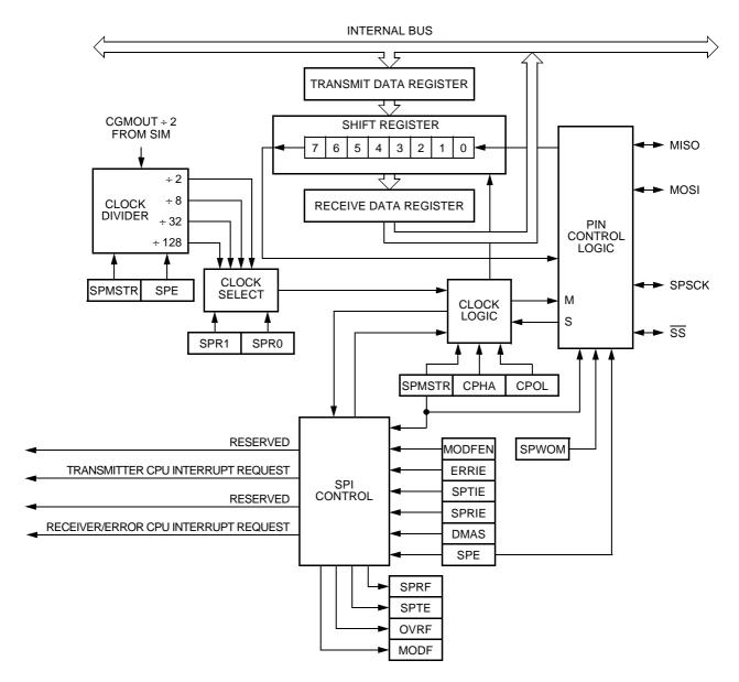
Figure 20-2. SPI Module Block Diagram
