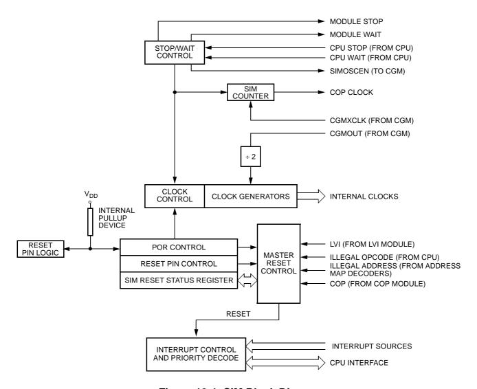
Figure 19-1. SIM Block Diagram
