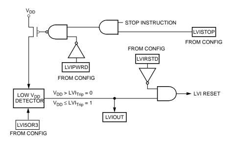
Figure 14-1. LVI Module Block Diagram
