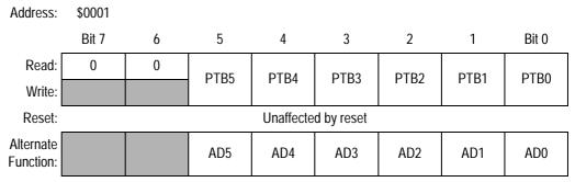
Figure 16-6. Port B Data Register (PTB)
