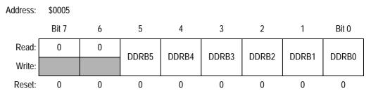
Figure 16-7. Data Direction Register B (DDRB)
