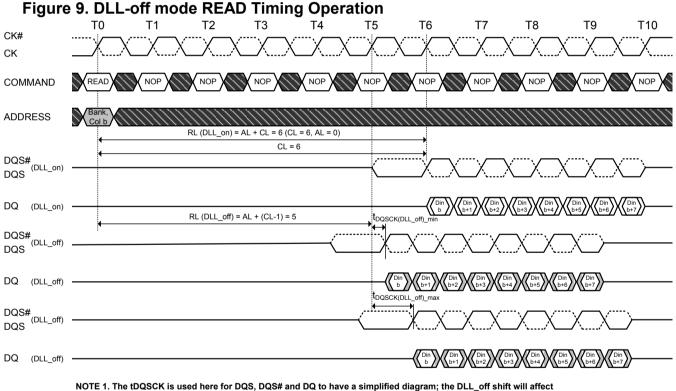
both timings in the same way and the skew between all DQ and DQS, DQS# signals will still be tDQSQ.
