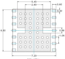
PCB METAL <u>TOP (X-RAY) VIEW</u> ONLY PACKAGE I/O'S AND GROUND REQUIREMENTS SHOWN.
