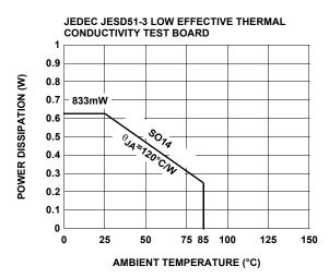
FIGURE 22. PACKAGE POWER DISSIPATION VS AMBIENT TEMPERATURE
