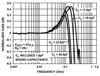
FIGURE 7. LARGE SIGNAL 0.1dB GAIN vs FREQUENCY vs  $C_L$
