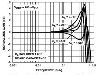
FIGURE 1. SMALL SIGNAL GAIN vs FREQUENCY vs  $\mathrm{C}_{\mathrm{L}}$
