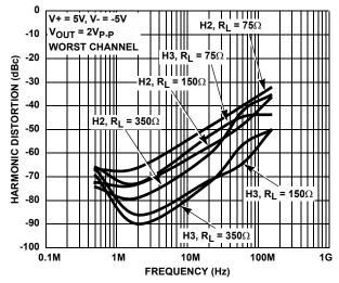
FIGURE 14. HARMONIC DISTORTION vs FREQUENCY
