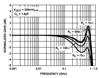
FIGURE 2. SMALL SIGNAL GAIN vs FREQUENCY vs  $\mathrm{R}_{\mathrm{L}}$
