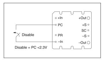
Figure 2 — Module enable/disable.
