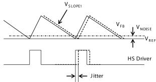
Figure 4: PWM-Mode Jitter
