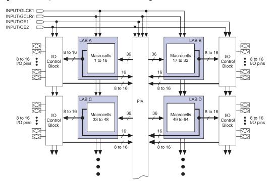
Figure 1. EPM7032, EPM7064 & EPM7096 Device Block Diagram
