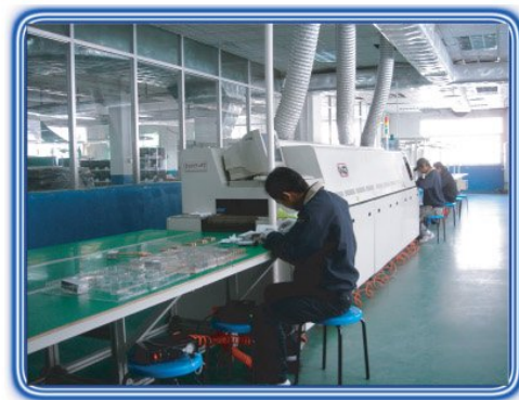
Reflow Oven 回焊爐車間
