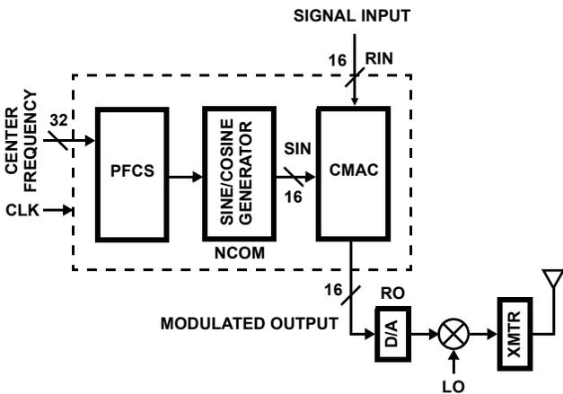
FIGURE 4. AMPLITUDE MODULATION
