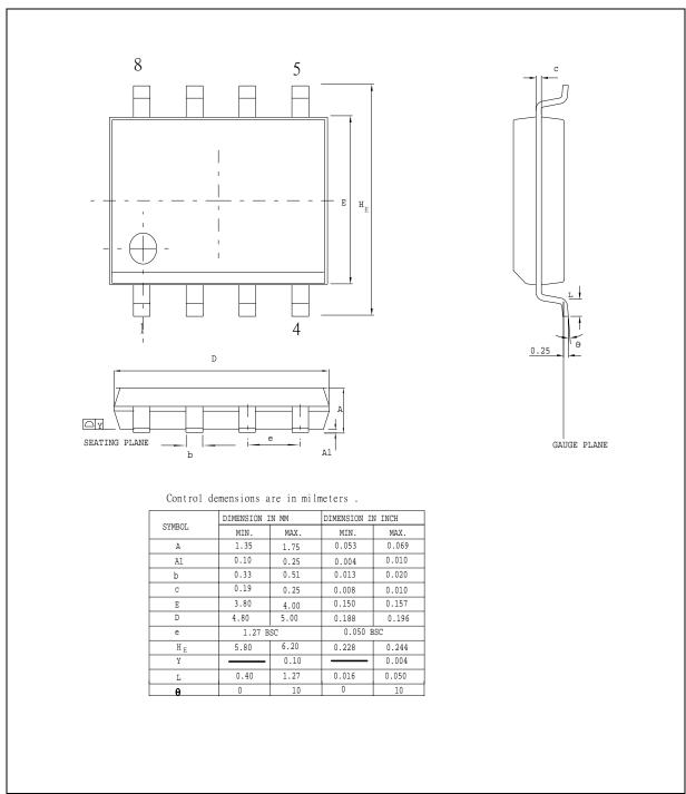
FIGURE 10: 8L 150MIL SOIC
