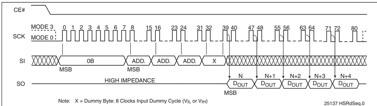
**FIGURE 4-4: HIGH-SPEED-READ SEQUENCE**
