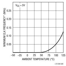
\* AS THE CLK FREQUENCY IS DECREASED FROM 1MHz, MINIMUM CLK FREQUENCY (∆ERROR ≤ 0.1LSB) REPRESENTS THE FREQUENCY AT WHICH A 0.1LSB SHIFT IN ANY CODE TRANSITION FROM ITS 1MHz VALUE IS FIRST DETECTED. 129346fs
