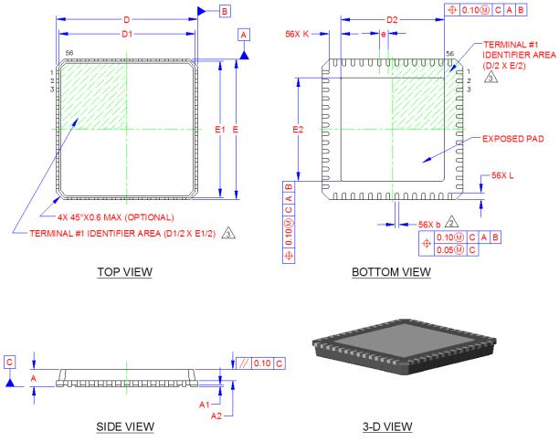
Figure 2 56-QFN Package
