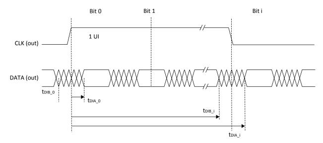
Figure 3.12. Transmitter DDRX71\_TX Waveforms
