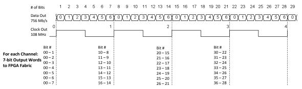
Figure 3.10. DDRX71 Video Timing Waveforms
