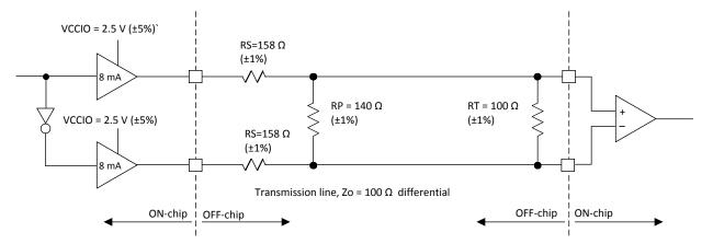
Figure 3.1. LVDS25E Output Termination Example
