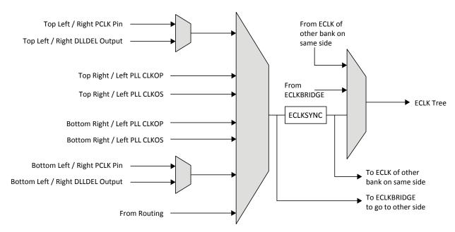
Figure 2.8. Edge Clock Sources per Bank
