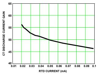
FIGURE 1. OSCILLATOR CT DISCHARGE CURRENT GAIN
