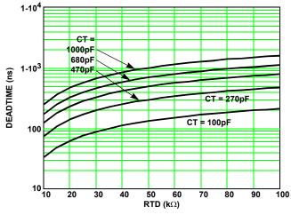
FIGURE 2. DEADTIME vs CAPACITANCE
