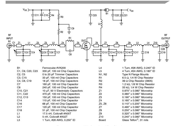
Figure 1. 135 - 175 MHz Broadband Test Circuit
